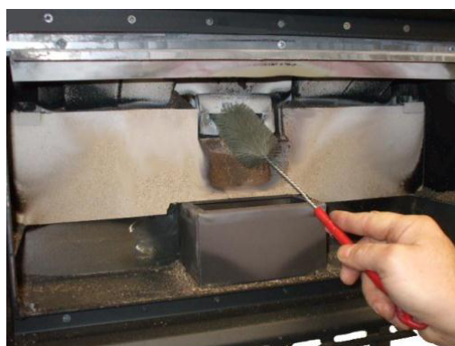
Fig. 35 - Reiniging met flessenwisser
