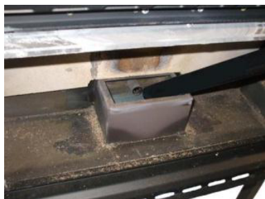
Fig. 36 - Reiniging ruimte vuurpot
