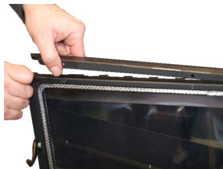
Fig. 48 - Door profiles removal
