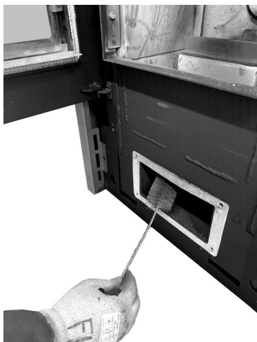
Fig. 62 - Reinig met pijpenwisser
