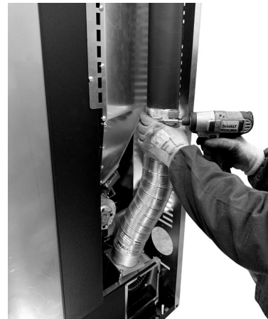
Fig. 51 - Bevestig de buizen
