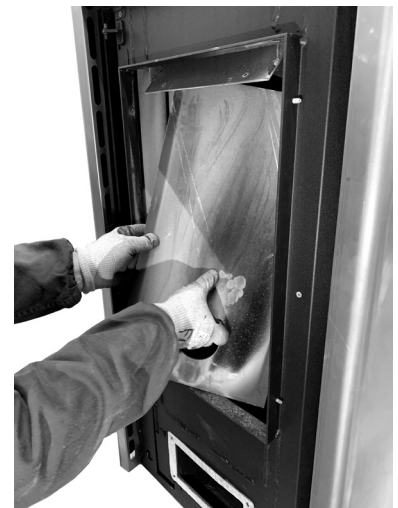
Fig. 69 - Verwijder het achterpaneel van de vuurhaard
