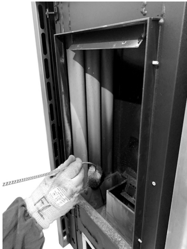
Fig. 70 - Reinig met pijpenwisser
