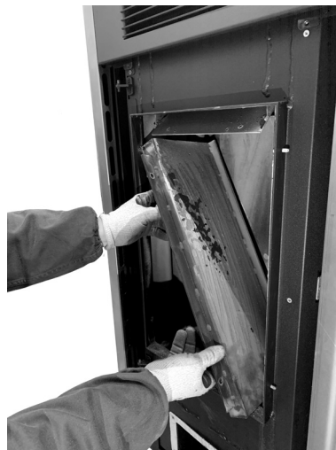
Fig. 68 - Verwijder de zijwanden
