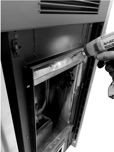
Fig. 64 - Verwijder de deflector
