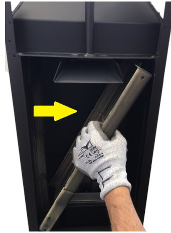
Fig. 46 - Verwijdering rookafvoer links
