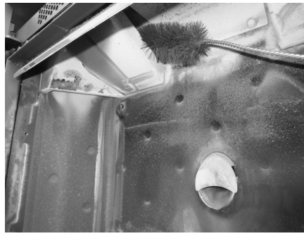
Fig. 35 - Reiniging met pijpenrager
