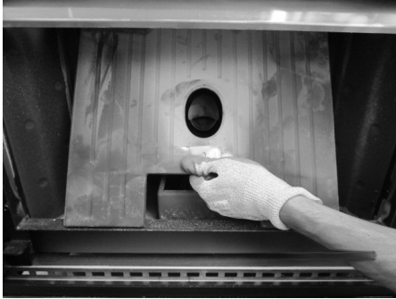
Fig. 34 - Verwijder de gietijzeren centrale wand
