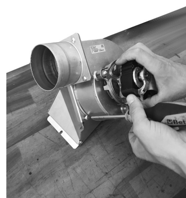
Fig. 35 - Draai de schroeven vast
