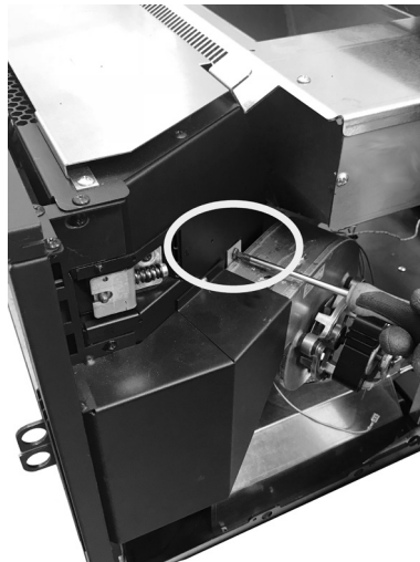
Fig. 68 - Verwijder de schroef 1
