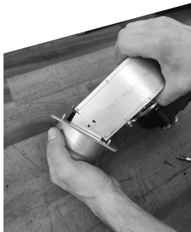
Fig. 31 - Bevestig de flens + de koppeling aan de ventilator
