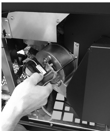
Fig. 28 - Verwijder de schroeven
