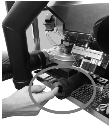
Fig. 50 - Verwijder de ring
