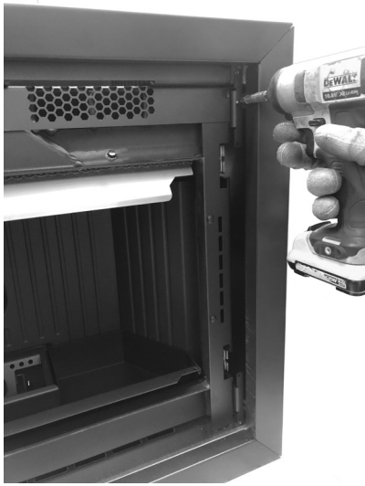
Fig. 18 - Verwijder de schroeven
