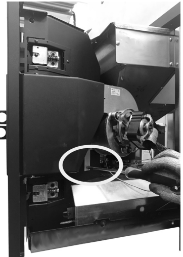
Fig. 69 - Verwijder de schroef 2
