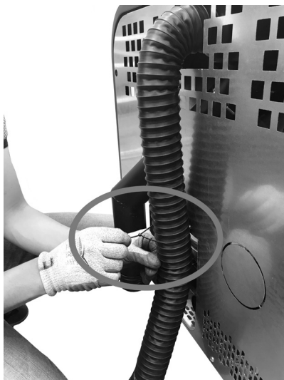
Fig. 52 - Bevestig met klem
