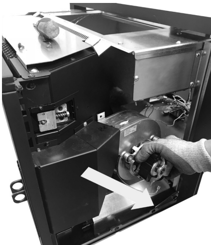
Fig. 70 - Verwijder de ventilator
