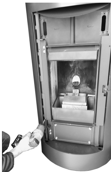
Fig. 64 - Verwijdering schroeven en profielen (rechts en links).
