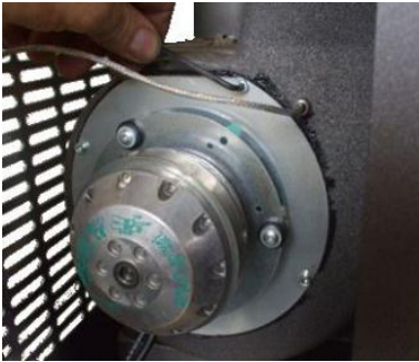
Fig. 37 - Reiniging rookgassenafzuiger: fase 1
