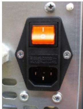
Fig. 21 - Elektrisch stopcontact met hoofdschakelaar
