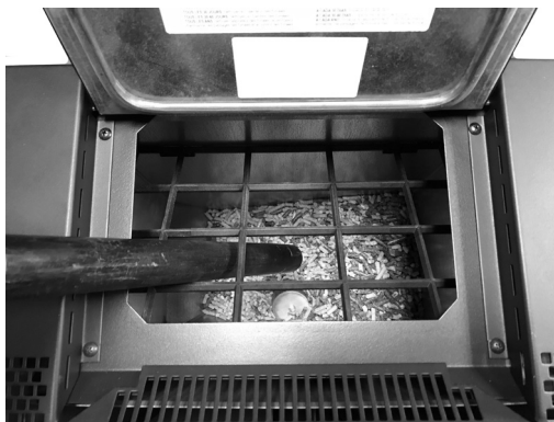
Fig. 26 - Reiniging van de voorraadbak en transportschroef
