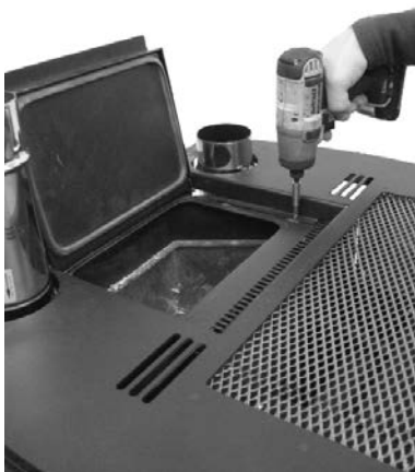
Fig. 41 - Verwijdering bovenste schroeven
