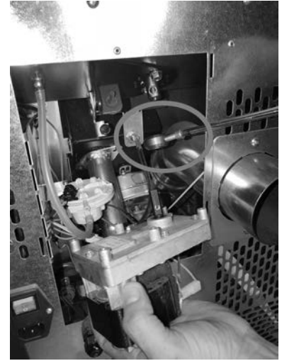
Fig. 72 - Verwijdering van de reductiemotor
