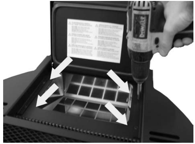
Fig. 82 - Verwijdering schroeven deksel 2
