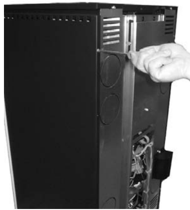
Fig. 76 - Verwijdering achterste schroef
