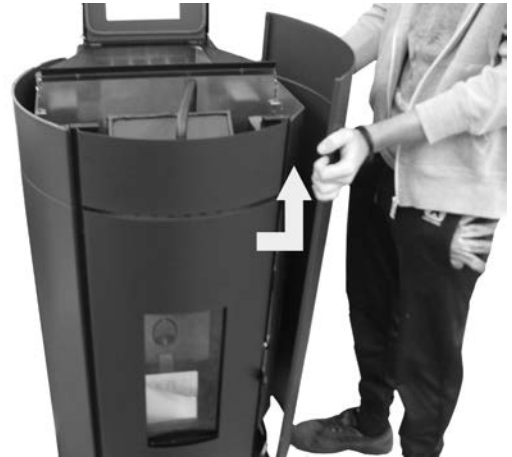
Fig. 84 - Het zijpaneel losmaken
