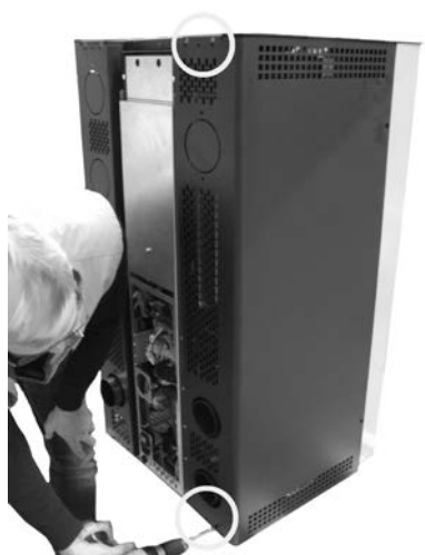
Fig. 94 - Verwijdering achterste schroeven
