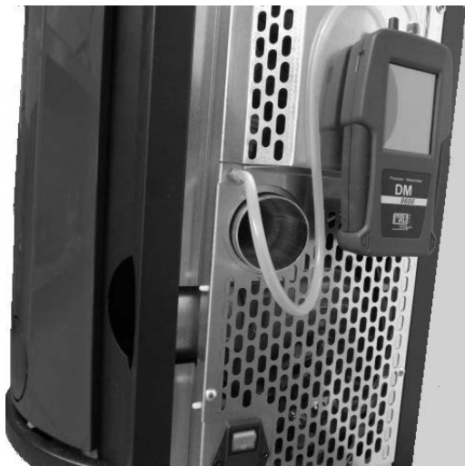
Fig. 55 - Aansluiting digitale drukregelaar
