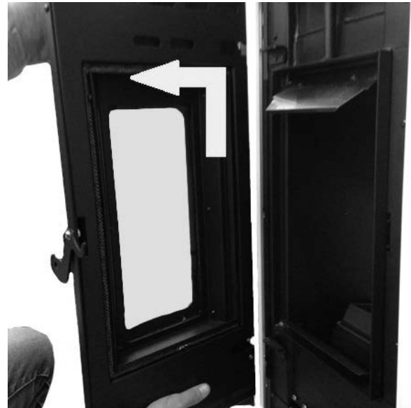
Fig. 86 - Verwijdering van de deur
