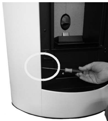
Fig. 88 - Draai de onderste schroef los
