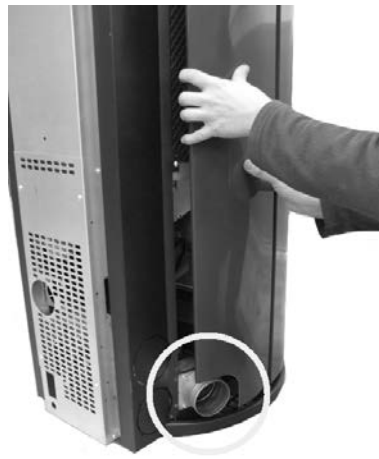
Fig. 37 - Montage paneel met gaten (model Sfera 3 Plus)
