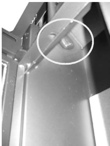
Fig. 96 - Passage van de rookgassen
