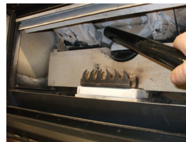
Fig. 38 - Pulizia parte superiore
