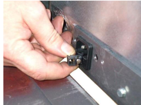
Fig. 56 - Substitution du fusible
