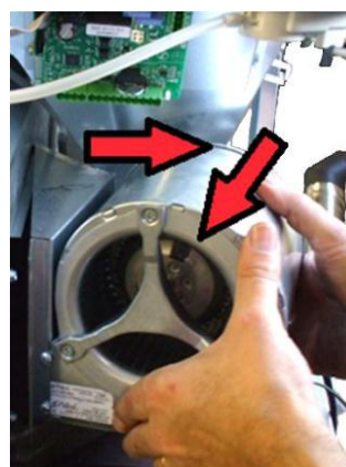
Fig. 54 - Rimozione del ventilatore
