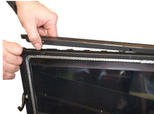
Fig. 48 - Extraction des profils de la porte
