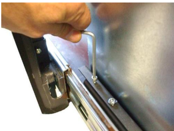
Fig. 20 - Vite posteriore di fissaggio inserto
