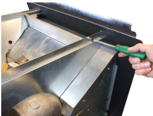
Fig. 51 - Devisser les vis de fixation carter
