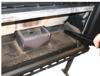
Fig. 37 - Nettoyage du logement du tiroir à cendre
