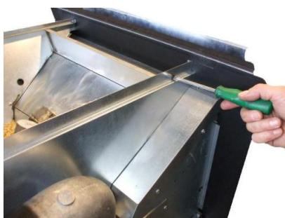
Fig. 51 - Svitare viti di fissaggio carter
