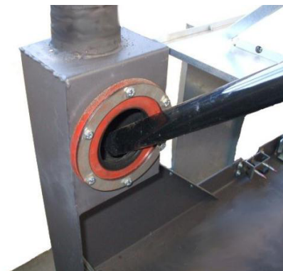
Fig. 41 - Pulizia canale da fumo
