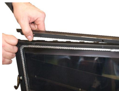
Fig. 48 - Rimozione profili porta
