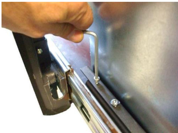
Fig. 20 - Vis postérieure de fixation de l'insert
