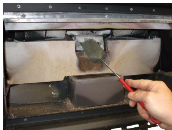
Fig. 35 - Nettoyage avec goupillon
