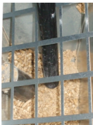
Fig. 39 - Pulizia serbatoio e coclea
