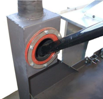
Fig. 41 - Nettoyage du collecteur de fumées
