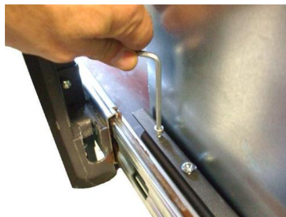
Fig. 15 - Vis postérieure de fixation insert
