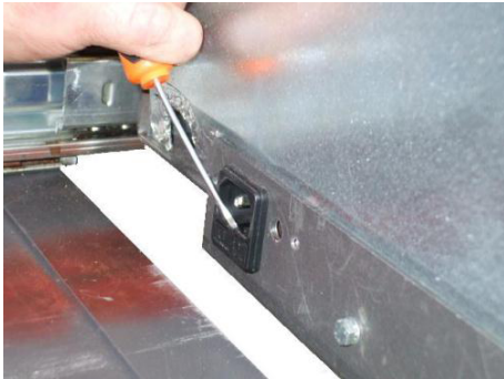
Fig. 55 - Enlevement du fusible sur la prise électrique
