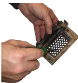
Fig. 32 - Nettoyage du brasero
