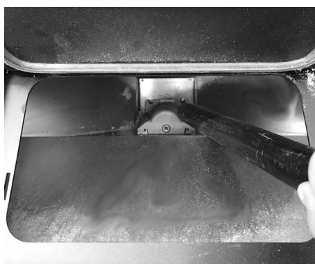
Fig. 25 - Reiniging van de voorraadbak en transportschroef
