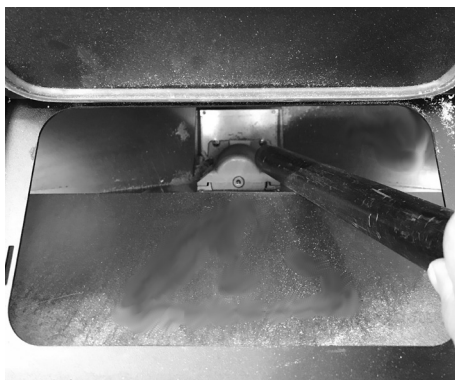
Fig. 22 - Nettoyage réservoir et vis sans fin
