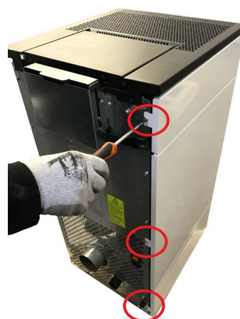
Fig. 23 - De zijpanelen bevestigen
