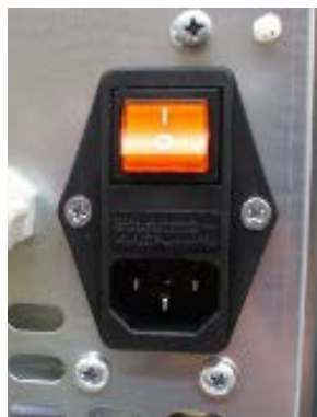
Fig. 29 - Elektrisch stopcontact met hoofdschakelaar
