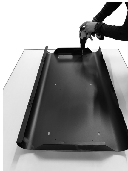
Fig. 55 - Visser la finition au panneau
