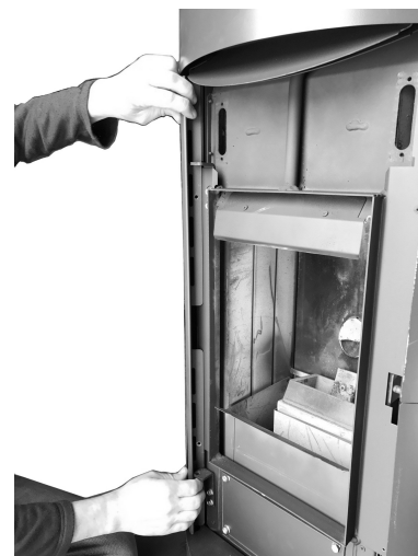
Fig. 70 - Retrait des profils avant (droit et gauche).
