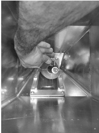
Fig. 85 - Retrait des spirales
