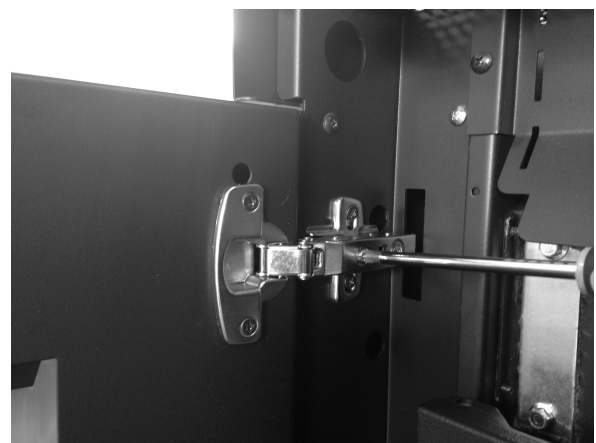
Fig. 48 - Réglage de la porte
