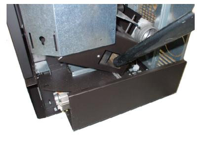
Fig. 73 - Nettoyage de la chambre des fumées
