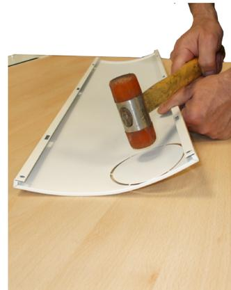
Fig. 29 - Ouvrir le trou (modèle Sfera<sup>3</sup> Plus)
