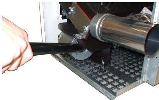
Fig. 79 - Nettoyage de le ventilateur ambiant
