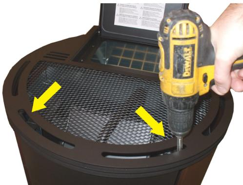
Fig. 62 - Enlèvement des vis du couvercle 1
