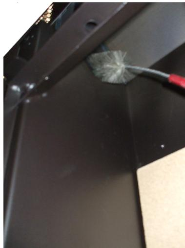
Fig. 69 - Nettoyage avec nettoie-pipes 1
