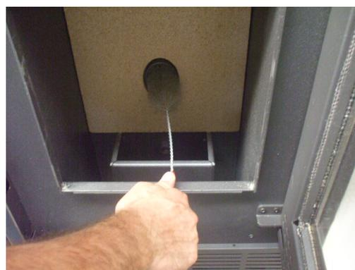
Fig. 54 - Nettoyage avec nettoie-pipes
