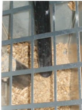
Fig. 55 - Nettoyage réservoir et vis sans fin
