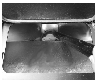
Fig. 33 - Nettoyage réservoir et vis sans fin
