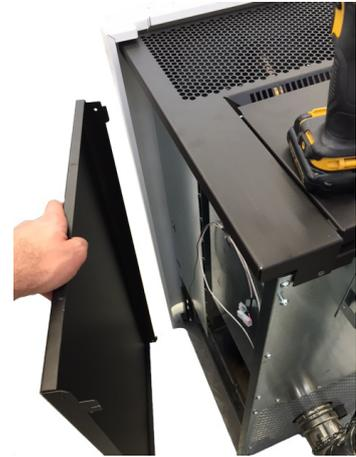
Fig. 26 - Dépose des côtés
