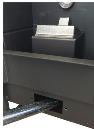
Fig. 46 - Nettoyage de la chambre des fumées
