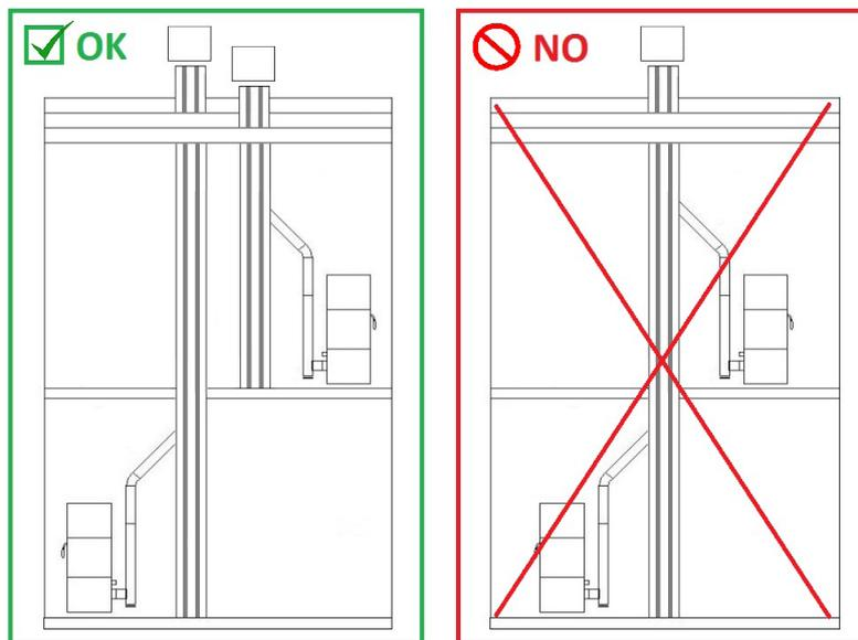
Fig. 14 - Exemples des installation correcte
