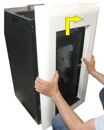
Fig. 28 - Décrocher l'encadrement
