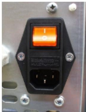
Fig. 33 - Prise électrique avec interrupteur général
