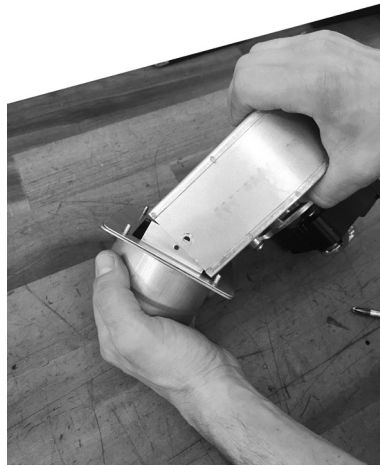
Fig. 40 - Fixer la bride + le raccord au ventilateur
