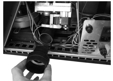
Fig. 68 - Enlever le raccord en silicone
