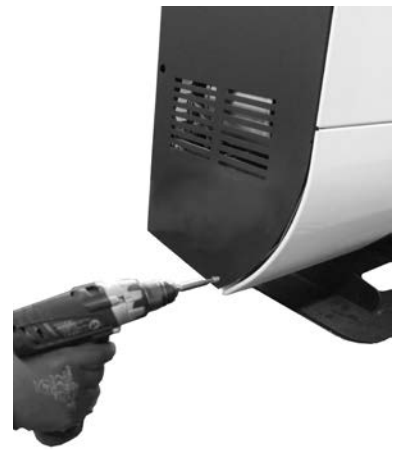
Fig. 38 - Fixation inférieure des panneaux
