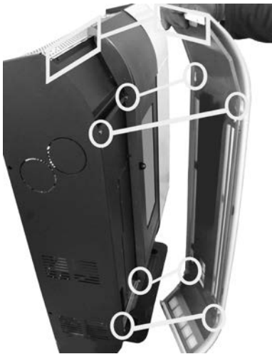
Fig. 36 - Insérer les panneaux
