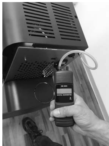
Fig. 53 - Connexion du pressostat numérique
