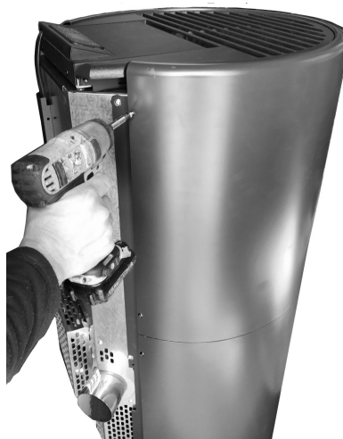
Fig. 71 - Retrait des vis arrière
