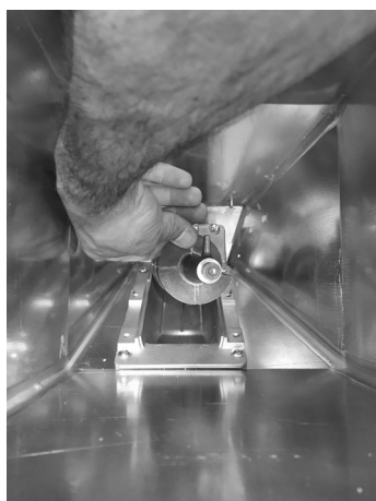
Fig. 85 - Retrait des spirales
