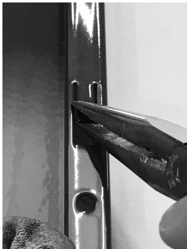
Fig. 50 - Plier les languettes
