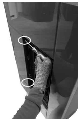
Fig. 36 - Fixation des vis
