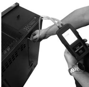
Fig. 71 - Raccordement du pressostat numérique
