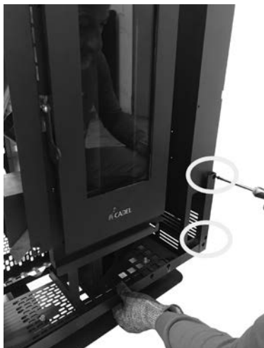
Fig. 44 - Fixation de l'étrier inférieur
