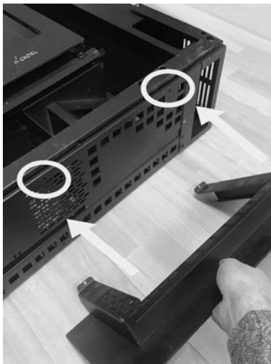
Fig. 61 - Mettre le piédestal en place
