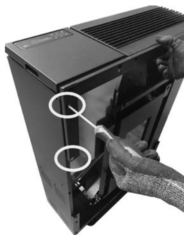
Fig. 45 - Fixation de l'étrier supérieur
