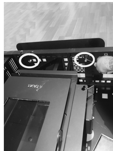
Fig. 46 - Blokkeer de schroeven
