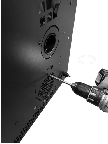
Fig. 62 - Verwijder de schroeven
