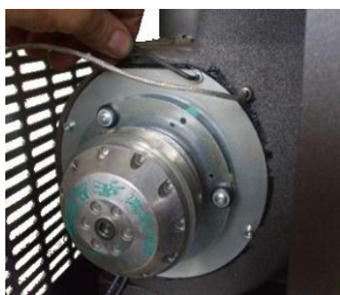
Fig. 37 - Nettoyage de l'aspirateur des fumées: phase 1
