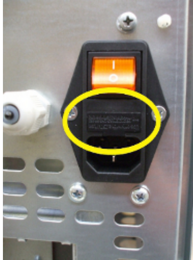
Fig. 45 - Hublot avec les fusibles à enlever
