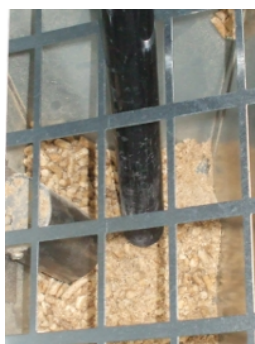
Fig. 33 - Pulizia serbatoio e coclea
