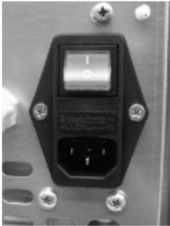
**Fig. 68 - Prise électrique avec interrupteur général**
