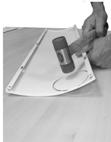
**Fig. 52 - Ouvrir le trou (modèle Sfera<sup>3</sup> Plus)**
