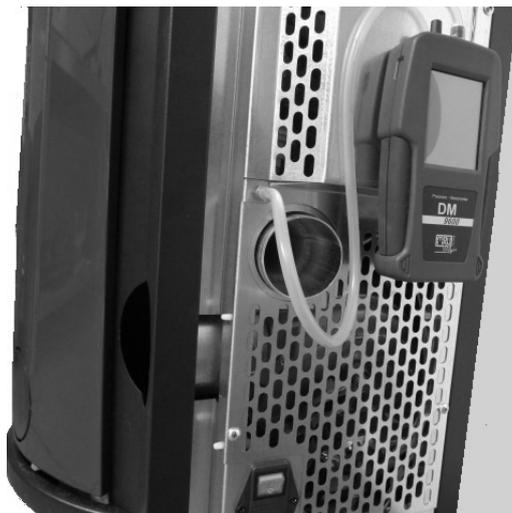
**Fig. 69 - Connexion du pressostat numérique**
