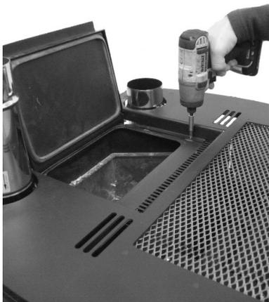
*Fig. 55 - Levée les vis supérieurs*
