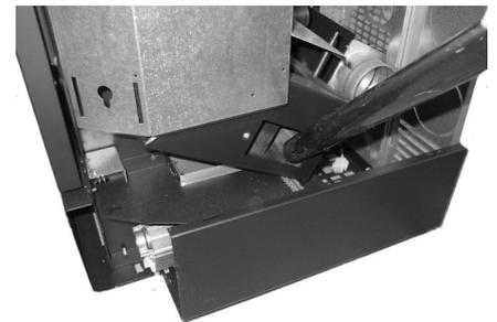
**Fig. 115 - Nettoyage de la chambre des fumées**
