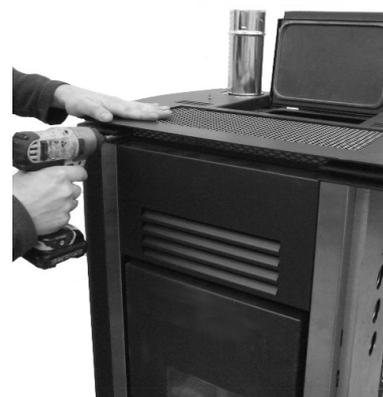
*Fig. 57 - Levée les vis frontal*
