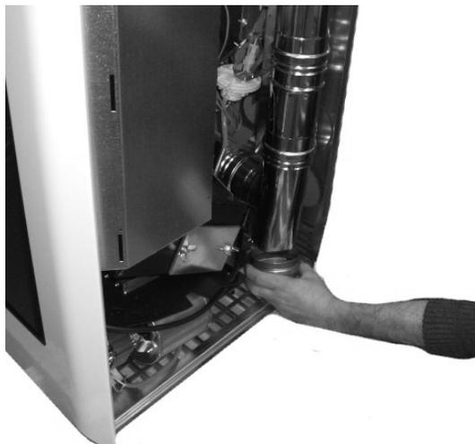
**Fig. 116 - Nettoyage du collecteur des fumées**
