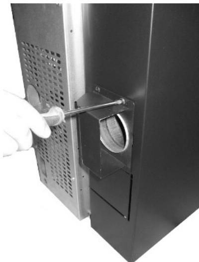
*Fig. 83 - Montage du diffuseur*
