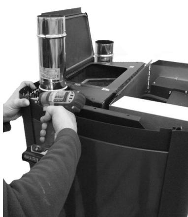
**Fig. 105 - Dépose des profils courbes supérieurs**
