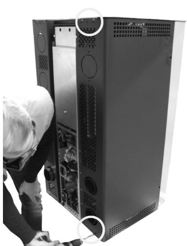
**Fig. 108 - Retrait des vis arrière**
