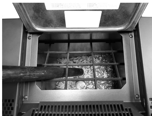
Fig. 26 - Nettoyage réservoir et vis sans fin
