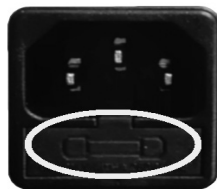
Fig. 36 - Hublot avec les fusibles à enlever
