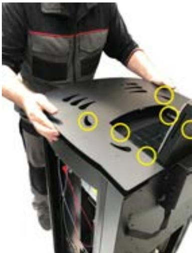
*Fig. 27 - Dépose du couvercle*
