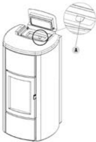
**Fig. 63 - Levier pour le nettoyage des turbulateurs (Idro Prince<sup>3</sup> 16-23-23 H2O, Aquos<sup>3</sup> 16-23-23 H2O, Idron 16-22 Airtight, Hidrofire 22.8)**
