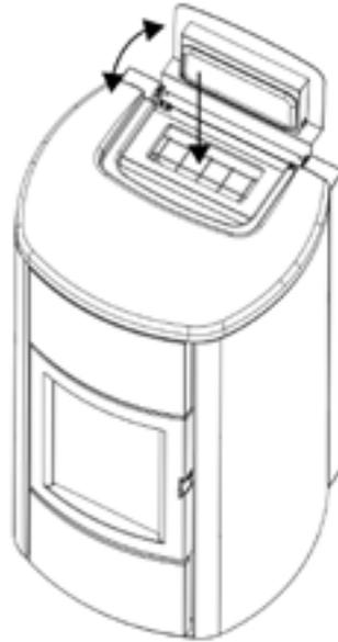
Fig. 37 - Remplissage des granulés
