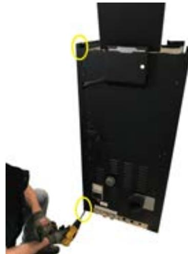
Fig. 36 - Fixation arrière du panneau latéral
