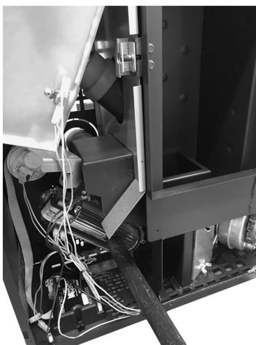
**Fig. 62 - Nettoyage de le ventilateur ambiant**
