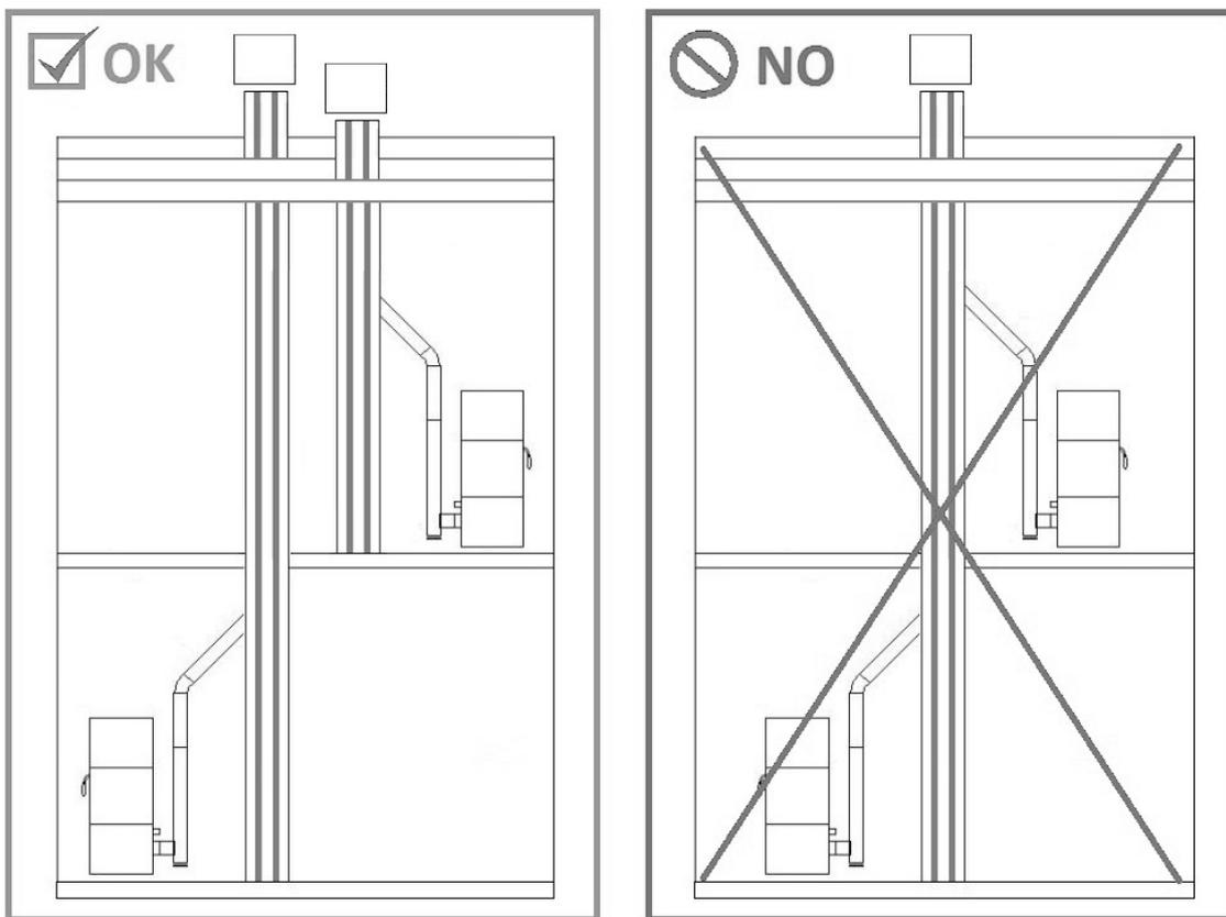
Fig. 9 - Exemples des installations correctes
