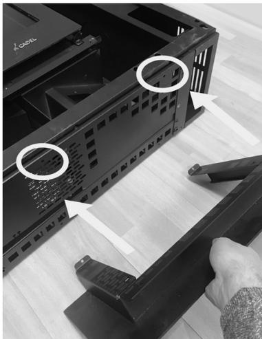
**Fig. 45 - Mettre le piédestal en place**
