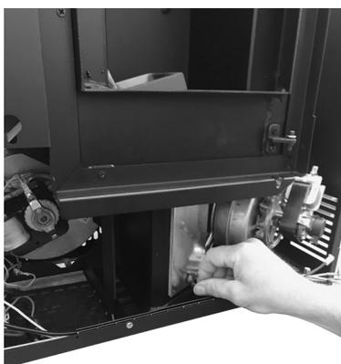
Fig. 57 - Retirer le bouchon d'inspection
