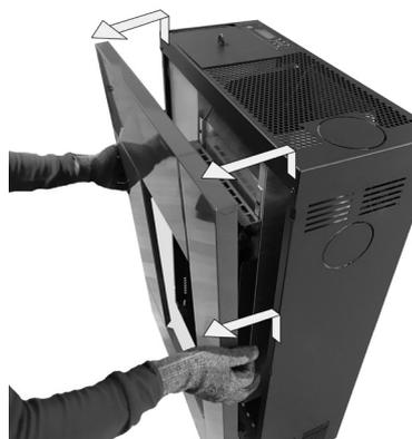
**Fig. 36 - Décrocher l'encadrement.**
