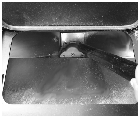
Fig. 23 - Nettoyage réservoir et vis sans fin
