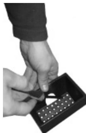
Fig. 34 - het schoonmaken van de vuurpot
