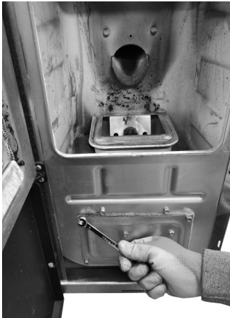
Fig. 67 - Verwijder de schroeven
