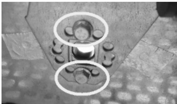
Fig. 75 - Verwijder de schroeven
