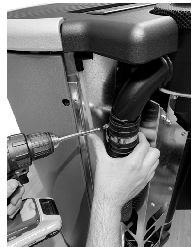
Fig. 52 - Flexibele buis naar buiten trekken
