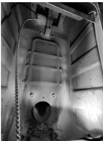
Fig. 71 - Reinig met pijpenwisser
