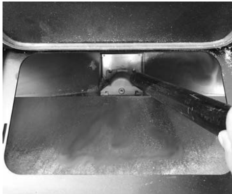
Fig. 35 - Reiniging van de voorraadbak en transportschroef
