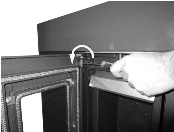
Fig. 17 - Verwijdering van de schroeven
