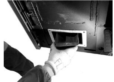
Fig. 85 - Verwijder de rookgasafleider
