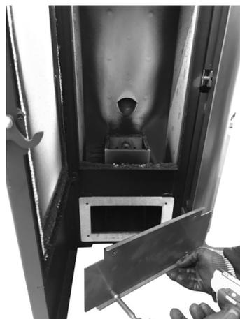
**Fig. 32 - Retirer le bouchon d'inspection**
