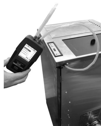
Fig. 29 - Connexion du pressostat numérique
