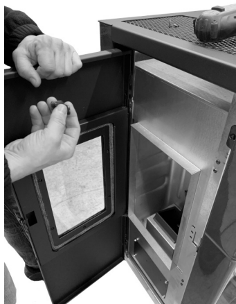
Fig. 17 - Verwijdering van de deur 2
