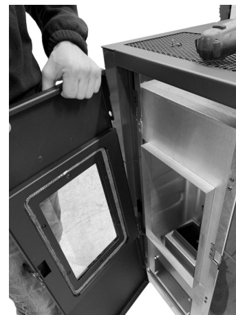
Fig. 18 - Verwijdering van de deur 3
