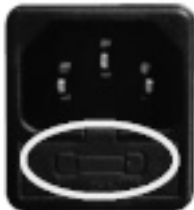
Fig. 81 - Hublot avec les fusibles à enlever
