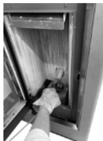
Fig. 34 - Nettoyage avec nettoie-pipes
