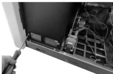
Fig. 107 - Nettoyage de le ventilateur ambiant
