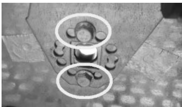
Fig. 101 - Verwijder de schroeven
