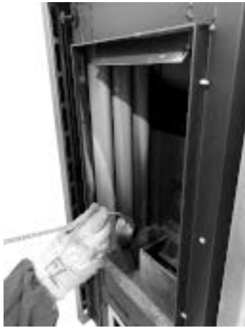
Fig. 92 - Reinig met pijpenwisser
