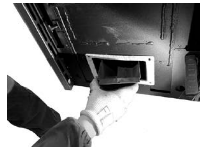
Fig. 96 - Verwijder de rookgasafleider
