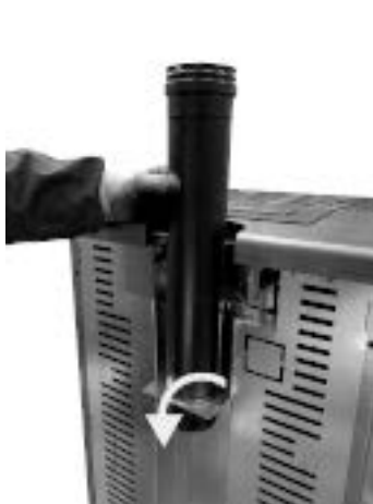
Fig. 57 - Laat de steun zakken
