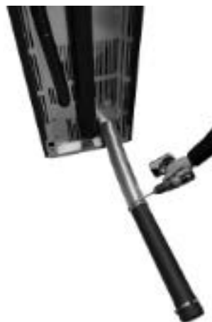
Fig. 72 - Buis met diam. 80 mm aansluiten
