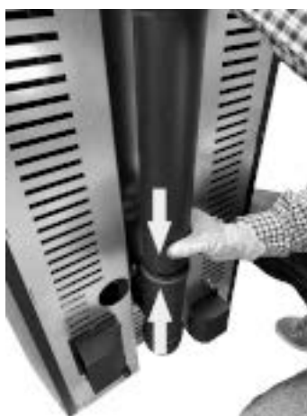
Fig. 58 - Sluit de buizen aan
