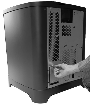
Fig. 32 - Nettoyage du conduit de fumée
