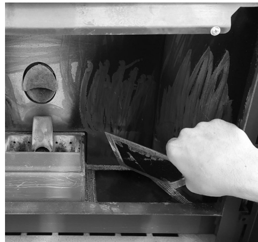
Fig. 34 - Retirer le bouchon d'inspection
