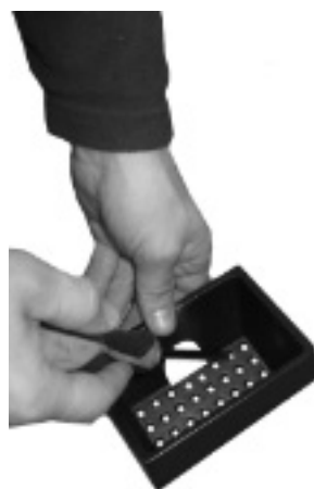
Fig. 33 - het schoonmaken van de vuurpot
