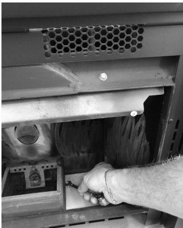
Fig. 24 - Verwijder de schroeven
