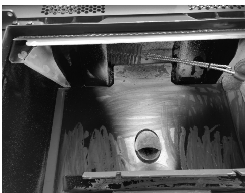
Fig. 28 - Reinig met pijpenwisser
