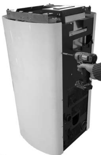
Fig. 56 - Retirer les vis postérieures
