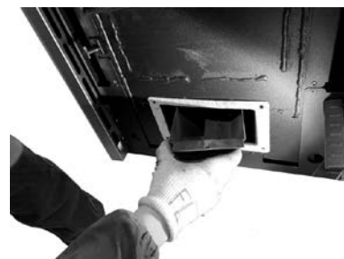
Fig. 105 - Ôter le déviateur de fumées
