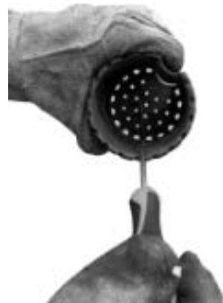
Fig. 34 - het schoonmaken van de vuurpot
