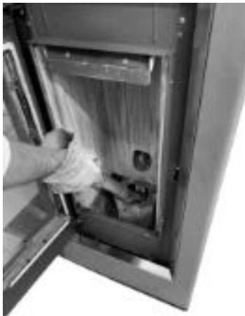
Fig. 35 - Reiniging ruimte vuurpot
