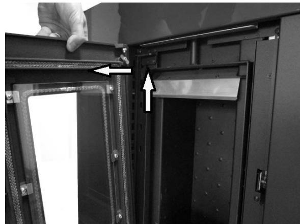
Fig. 20 - Verwijdering van de deur
