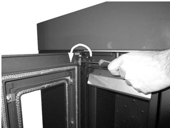
Fig. 19 - Verwijdering van de schroeven
