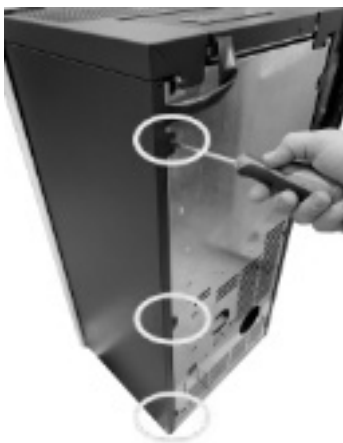
Fig. 38 - Retirer les vis
