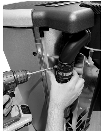
Fig. 62 - Extraire le tuyau flexible
