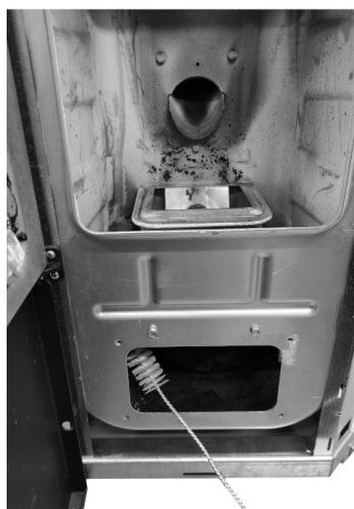
Fig. 79 - Nettoyer avec un goupillon.
