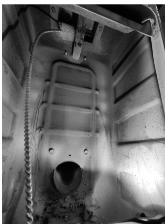
Fig. 81 - Nettoyer avec un goupillon.
