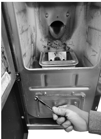
Fig. 77 - Retirer les vis
