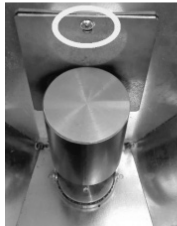
Fig. 86 - Retrait des vis
