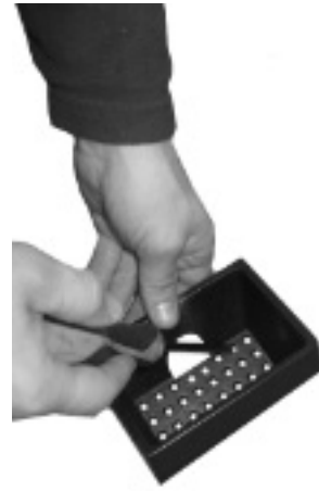
Fig. 38 - het schoonmaken van de vuurpot
