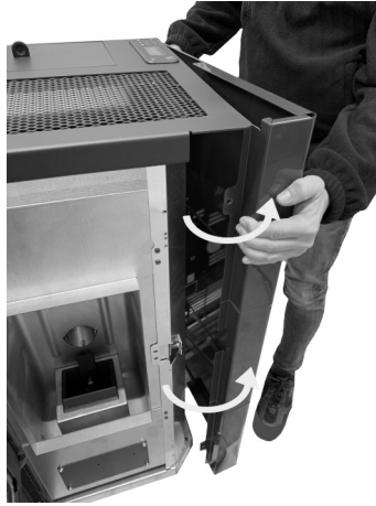
Fig. 33 - De zijpanelen draaien
