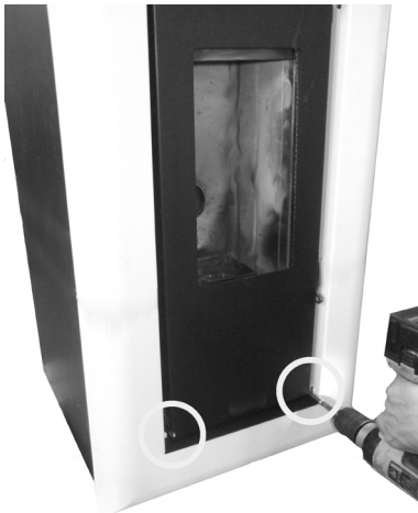
Fig. 26 - Verwijder de schroeven
