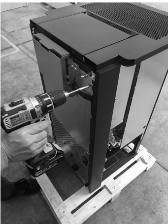
Fig. 35 - Verwijder het zwarte profiel
