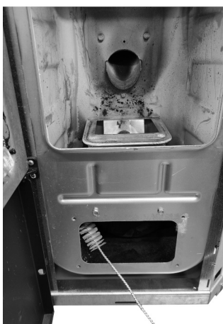
Fig. 70 - Reinig met pijpenwisser
