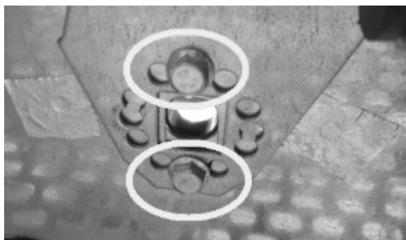
Fig. 76 - Verwijder de schroeven
