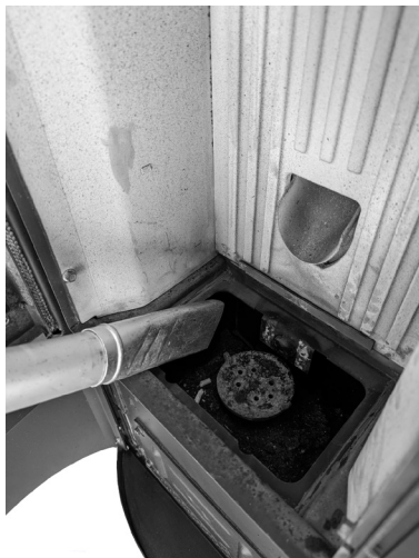
Fig. 38 - Reiniging ruimte vuurpot
