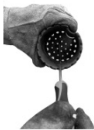
Fig. 33 - het schoonmaken van de vuurpot
