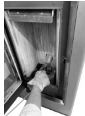
Fig. 39 - Reiniging met flessenwisser
