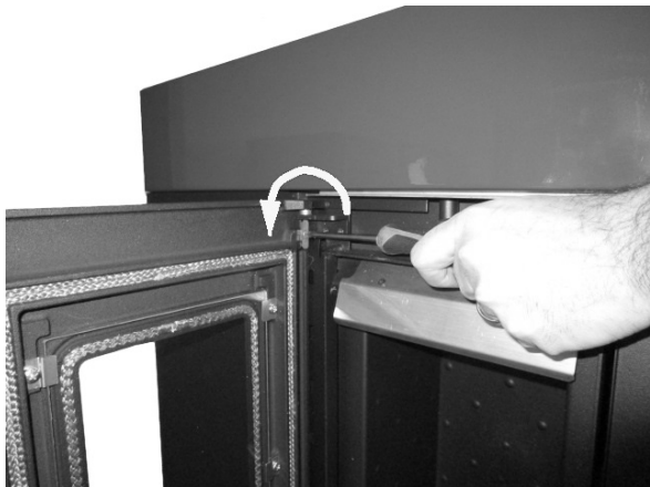
Fig. 15 - Verwijdering van de schroeven
