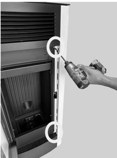
Fig. 26 - De schroeven verwijderen
