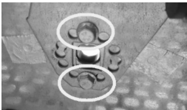
Fig. 60 - Verwijder de schroeven
