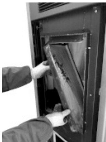
Fig. 49 - Verwijder de zijwanden
