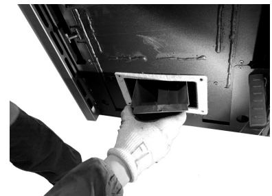
Fig. 55 - Verwijder de rookgasafleider
