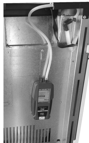
Fig. 36 - Aansluiting digitale drukregelaar
