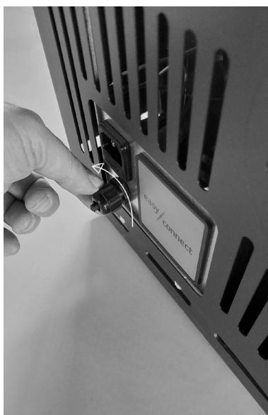
Fig. 37 - Draai de moer los
