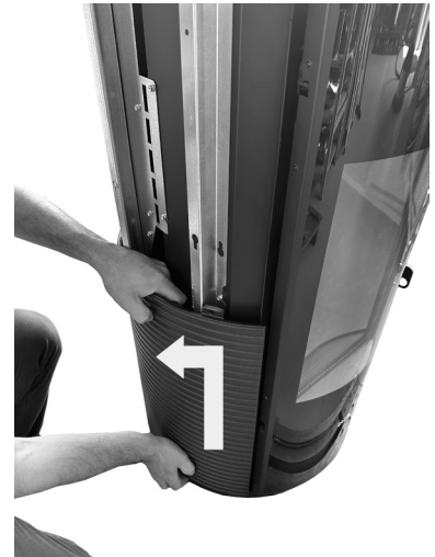
Fig. 25 - Verwijder de bodemplaat
