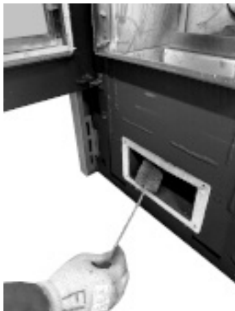
Fig. 42 - Reinig met pijpenwisser
