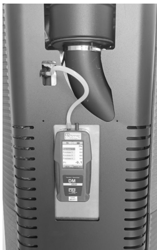
Fig. 35 - Aansluiting digitale drukregelaar
