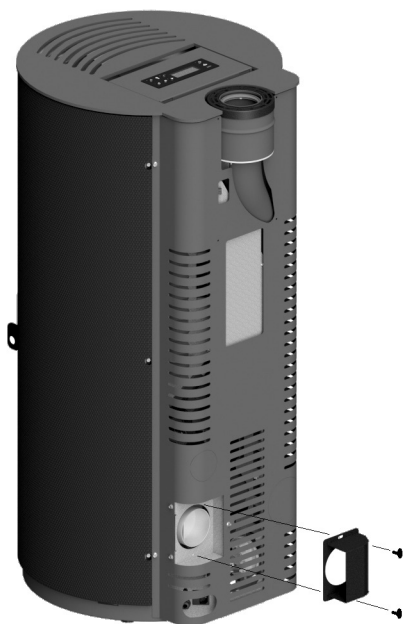
Fig. 30 - Verwijder de omleider
